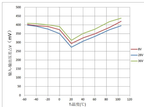
图6 输入-输出压差ΔV 与温度特性
