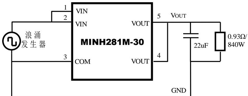
图2 MINH281M-30 测试电路图
