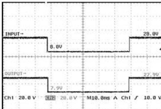
图4 欠压浪涌输入输出波形
