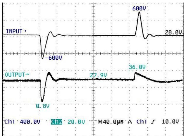
图5 尖峰脉冲输入-输出波形
